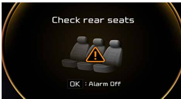
Nhắc nhở kiểm tra hàng ghế sau (ROA - Rear Occupant Alert)
