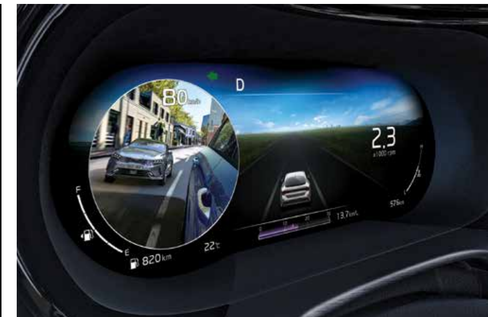
Quan sát điểm mù qua hình ảnh (BVM - Blind-spot View Monitor)
