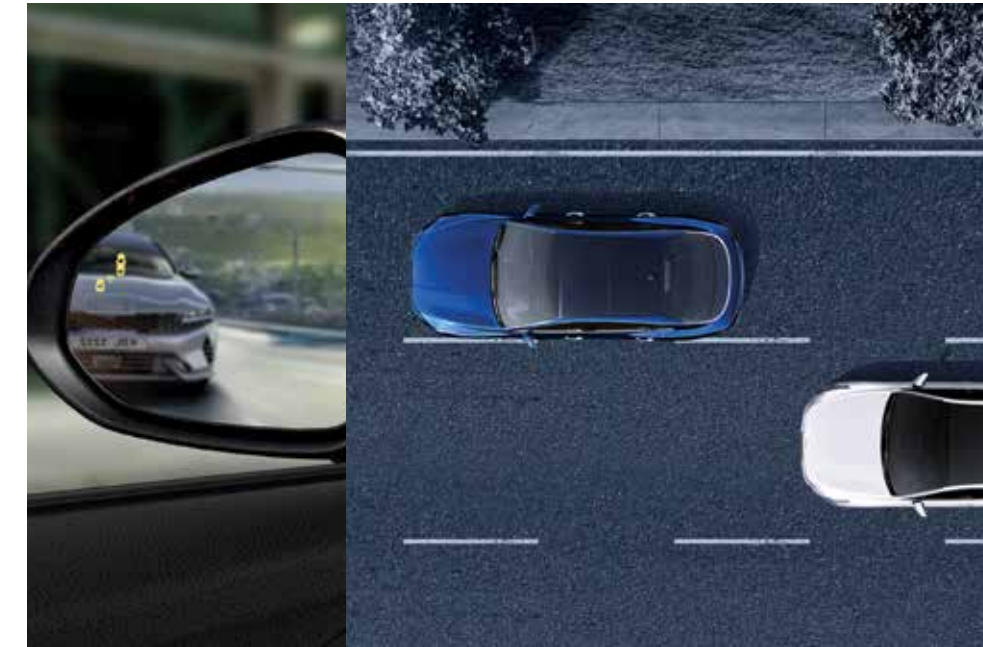
Cảnh báo điểm mù (BCW - Blind-spot Collision Warning)
