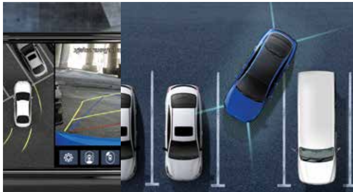
Camera quan sát toàn cảnh (SVM - Surround View Monitor)
