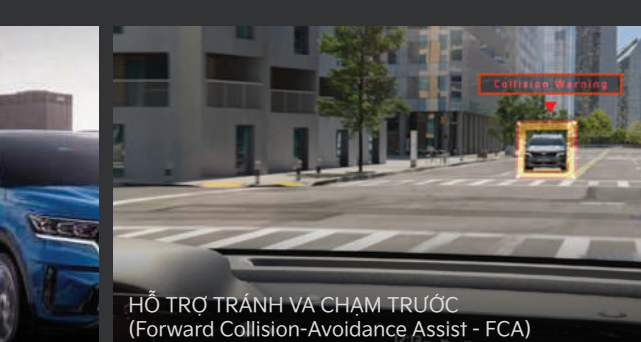
HỖ TRỢ TRÁNH VÀ CHẠM TRƯỚC (Forward Collision-Avoidance Assist - FCA) Hệ thống đánh giá nguy cơ va chạm giữa xe với vật thể phía trước và đưa ra cảnh báo cho người lái, đồng thời hỗ trợ phanh khẩn cấp trong tình huống nguy hiểm.
