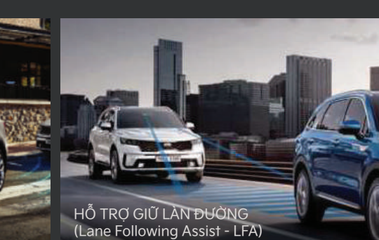
HỖ TRỢ GIỮ LÀN ĐƯỜNG (Lane Following Assist - LFA) Hệ thống hỗ trợ giữ làn đường có thể nhận ra các vạch kẻ đường và hỗ trợ đánh lái để giữ xe luôn đi ở trung tâm làn đường.
