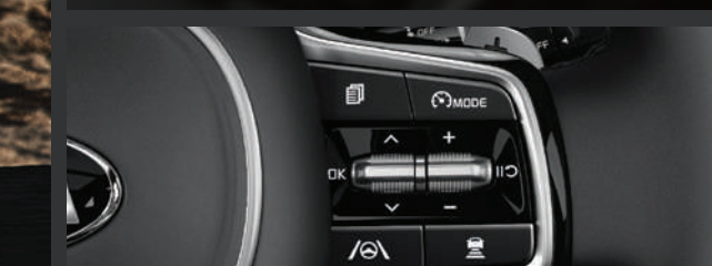
ĐIỀU KHIỂN HÀNH TRÌNH THÔNG MINH (Smart Cruise Control - SCC) Hệ thống tính toán vị trí tương đối so với phương tiện phía trước để đảm bảo cự ly an toàn giữa 2 xe khi lưu thông trên đường.
